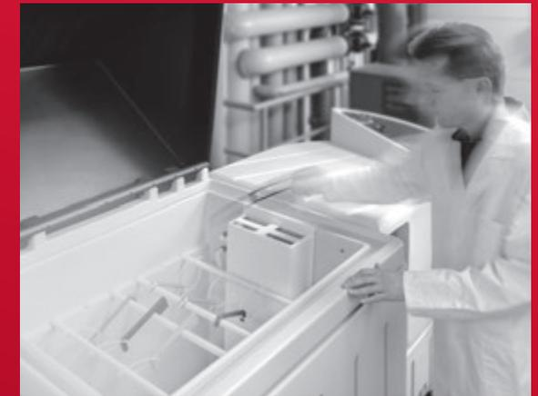
Test technique de résistance à la corrosion dans l'enceinte d'essai de brouillard salin
